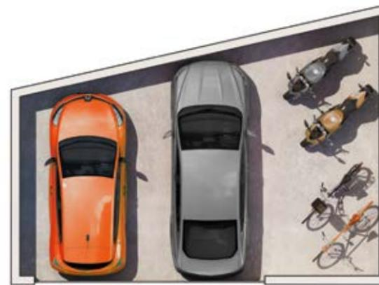
Konischer Verlauf der Rückwand (notwendig z. B. aufgrund des Grenzverlaufs). Seitliche Stellfläche für Fahrräder etc. vorhanden durch seitliche Verbreiterung nach rechts.
